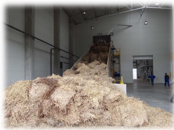
Rysunek 4: Węzeł szarpiąco-rozdrabniający. Przykładowe rozwiązanie
